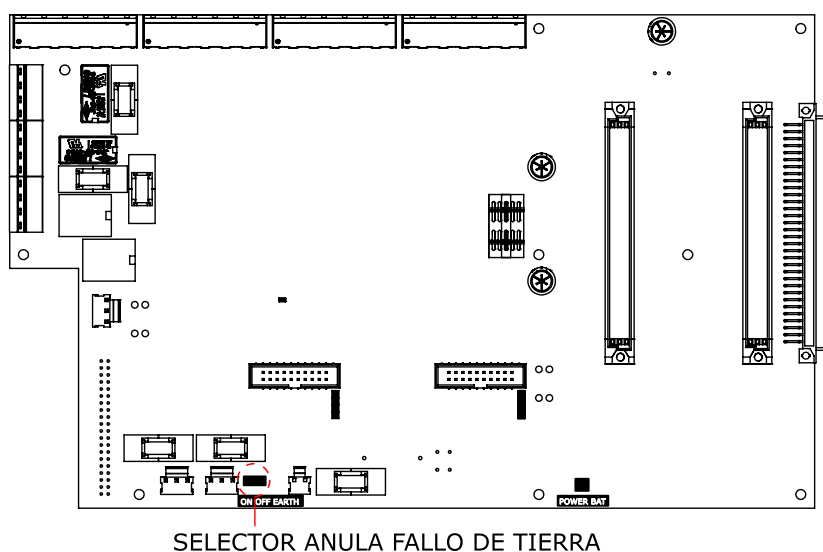
Fig. 30 Localización del selector de anulación de Fallo de Tierra
