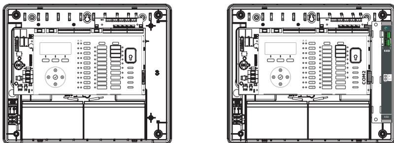
La conexión de la tarjeta TRED-200 a la placa base de la Central se realiza mediante el conector de cinta plana de 20 vías, del conector COM IN de la tarjeta al puerto COM2 de la Central.
